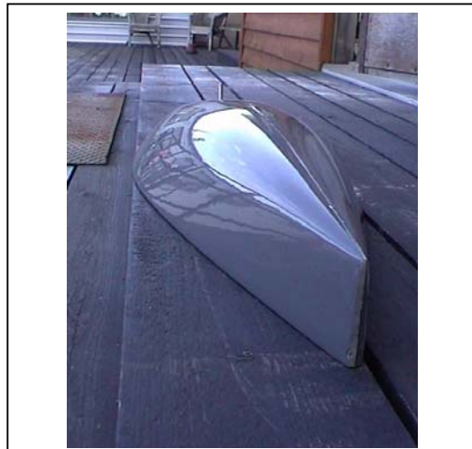
Aero runko nro. 3. Laminoitu polyesterillä ja katkokuidulla. Pinnassa pigmentillä tummanharmaaksi värjätystä polyesterhartsi- piituhkaseoksesta tehty "gelcoat"
