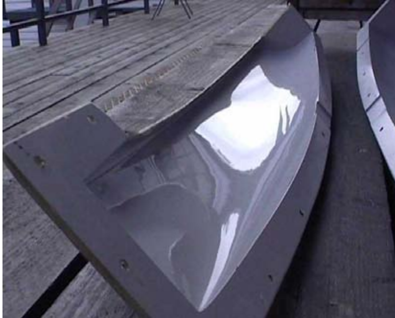
Käyttövalmis, vesihiottu ja kiillotettu muotti
