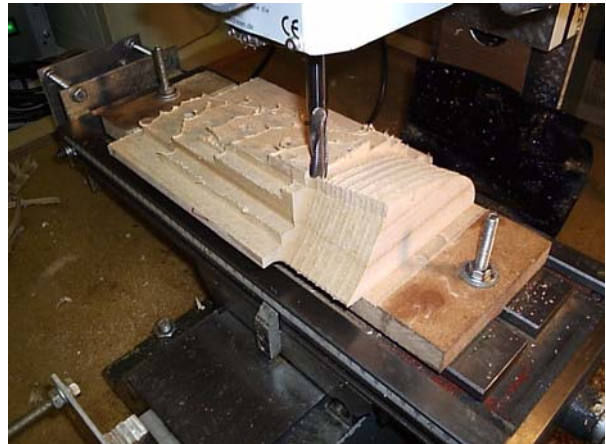
Rouhinnan(vas.) ja viimeistelyajon(oik.) aikana neliskulmaisesta MDF palasta syntyy tarkka plugin osa aivan automaattisesti: jyrsinnän aikana operaattori ei tarvitse tehdä muuta kuin pyörittää peukaloitaan !
