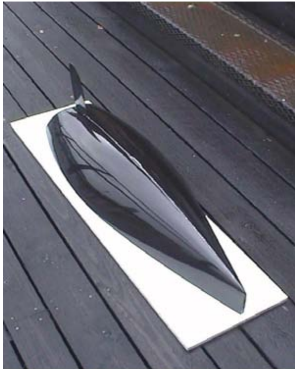
Aero runko nro. 4, neljän vuoden veneenrakennus-harjoittelun tulos: rungossa on virheetön musta "peilipinta" Runko on laminoitu epoksilla, ja pinnassa on käytetty mustaa epoksigelcoatia. Tämä runko käytetään kaudeksi 2005 rakennettavaan veneeseen.
