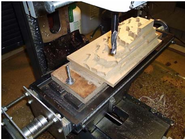
Rouhinnan(vas.) ja viimeistelyajon(oik.) aikana neliskulmaisesta MDF palasta syntyy tarkka plugin osa aivan automaattisesti: jyrsinnän aikana operaattori ei tarvitse tehdä muuta kuin pyörittää peukaloitaan !
